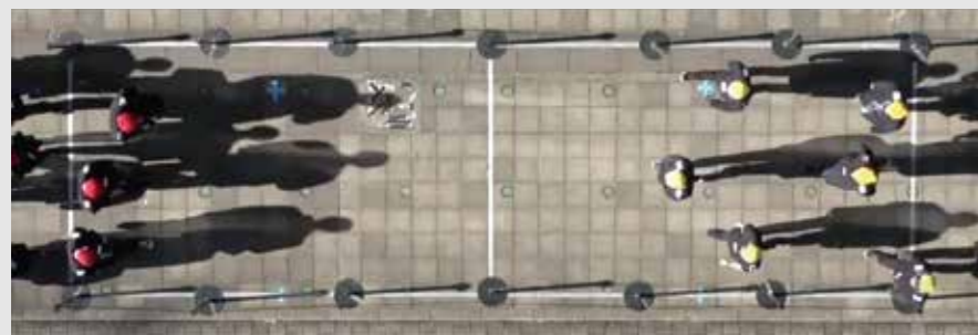
レーン形成実験を上空から撮影したスナップショット。横断歩道を模した通路を、黄（赤）色の帽子を被った歩行者集団が右（左）から左（右）へ移動する。
